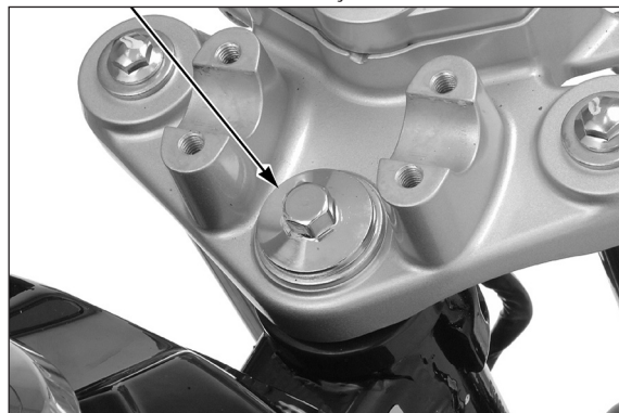
PORCA DA COLUNA DE DIREÇÃO
