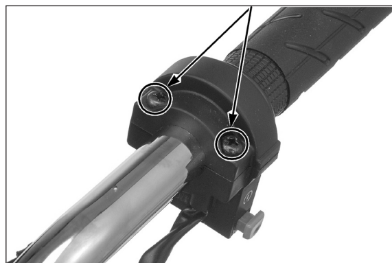
ALOJAMENTO DO ACELERADOR/ INTERRUPTOR DO GUIDÃO DIREITO
