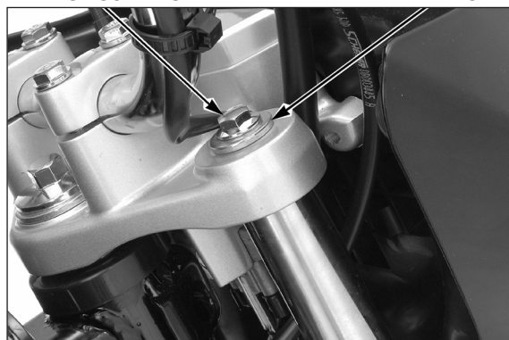
PARAFUSO DE FIXAÇÃO DA MESA SUPERIOR
